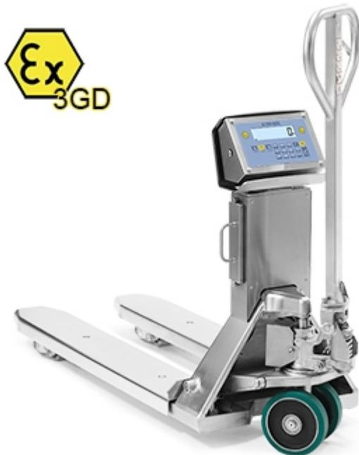
ATEX-Gabelhubwaage für den Einsatz in explosionsgefährdeten Bereichen (ZONEN 2 und 22) in den Schutzarten Ex II 3G IIC T6 Gc X und Ex II 3D IIIC T115C° Dc X. Aufbau komplett aus Edelstahl. Auch in einer für die Verwendung mit Dritten zugelassenen Version erhältlich. Hergestellt, kalibriert und geeicht in Italien von Dini Argeo, unter Verwendung zertifizierter Prüfmassen.
