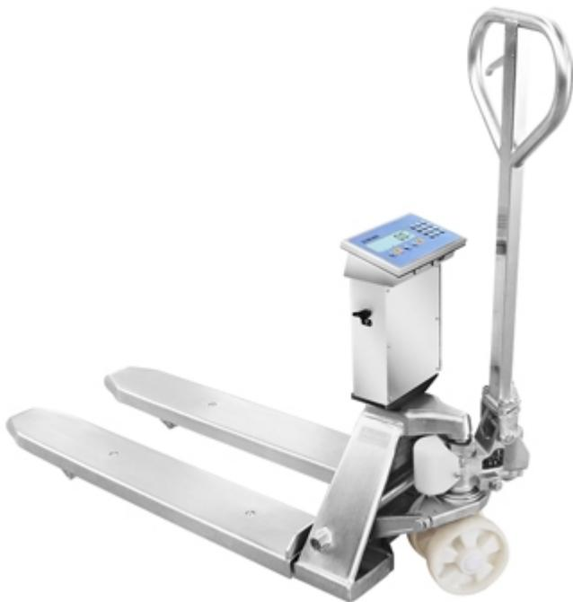
Edelstahl-Gabelhubwagen mit Waagenfunktion, integrierte Mehrbereichs-Wägeelektronik. Ausgestattet mit 4 Edelstahl-Wägezellen, Schutzart IP68 . Einfach im Gebrauch, robust und geeignet für den Einsatz im rauen Arbeitsumfeld. Hergestellt, kalibriert und geeicht in Italien von Dini Argeo, unter Verwendung zertifizierter Prüfmassen. Verfügbar auch in eichfähigen Versionen (CE-M).
