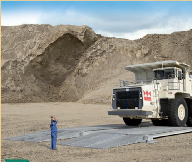
Beispiel: Mobile Fahrzeugwaage mit doppelter Spurbreite für XXL Minenfahrzeuge
